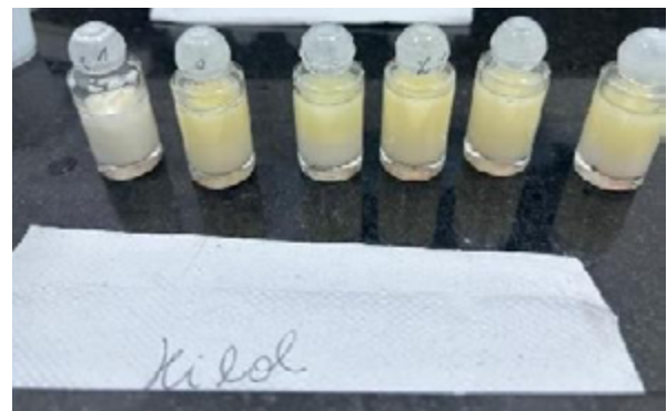
Figura 13 - Resultado do solvente xilol com tergentol após 15 minutos, já agitado.
