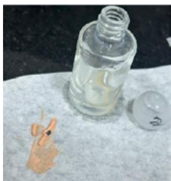
Figura 14 - Resultado do solvente xilol sobre cones de guta-percha.
