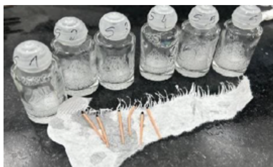
Figura 18 - Resultado do soro fisiológico 0.9% nos cones de guta-percha.
